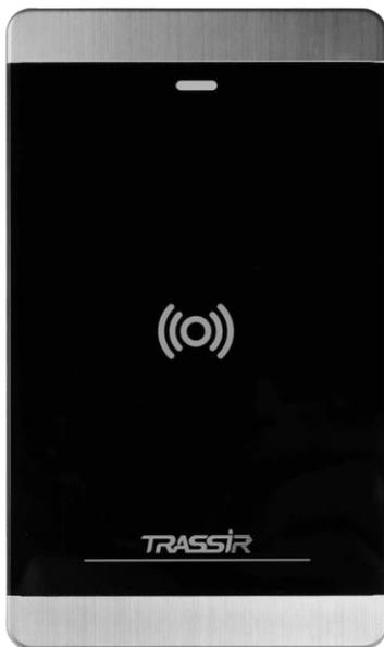
**TR-R1M** - считыватель карт, оснащенный 32-х битным высокоскоростным процессором. Связь с контроллером доступа осуществляется через протокол RS-485 или протокол Wiegand. Встроенный модуль защиты сохраняет считыватель карт от взлома. Материал PC+ABS, в котором выполнен считыватель, обеспечивает водо- и пыленепроницаемость. Считыватель адаптирован к эксплуатации на улице: защита от пыли и влаги — IP64.
